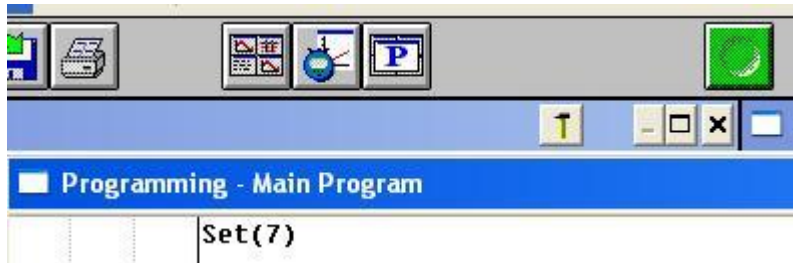
Obr. 2 Zapnutie výstupu 4 (zdiery číslo 7). Pre číslovanie výstupov pozri kapitolu 5.1
