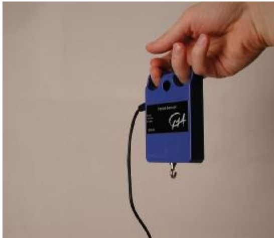
Obrázok 3. Senzor sily je možné držať v ruke, alebo upevniť k statívovej súprave
