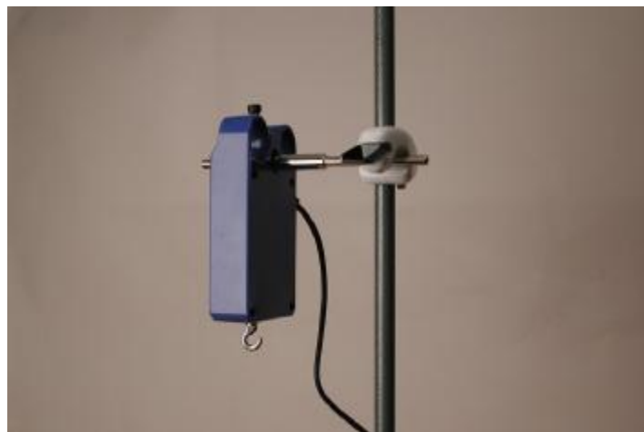
Obrázok 3. Senzor sily je možné držať v ruke, alebo upevniť k statívovej súprave
