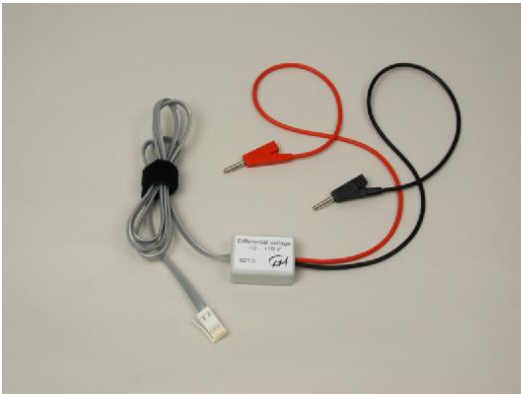
Obrázok 1. Diferenčný senzor napätia -10 .. +10 V
